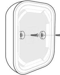
2. Placez la sirène sur le panneau SmartBracket et tournez-la dans le sens des aiguilles d'une montre. Ensuite, fixez l'appareil avec une vis.
