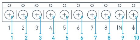
IMAGE 16. Sorties principales et entrée « N » du récepteur
