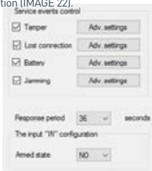
IMAGE 22. Menu de réglage des sorties de service à la page « Zones radio »
