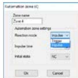
IMAGE 20. Réglages de la zone d'automatisation
