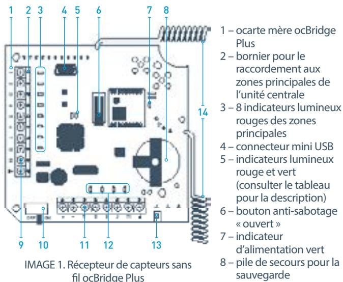
IMAGE 1. Récepteur de capteurs sans fil ocBridge Plus
