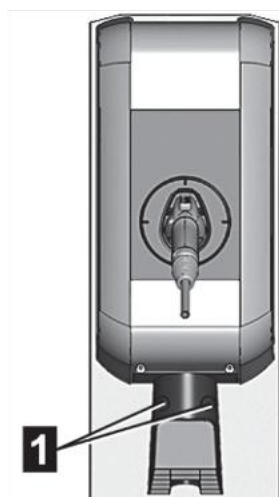
Support pour câble de recharge
