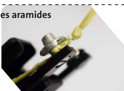
Enrouler les aramides sous les plaquettes de serrage
