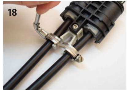
18 Placer et serrer les colliers sur la bride et les câbles
